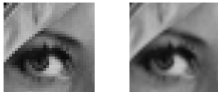
Fig. 2.22. Efect de mărire (“zoom”) prin interpolare de ordin zero (stânga) și liniară (dreapta)
