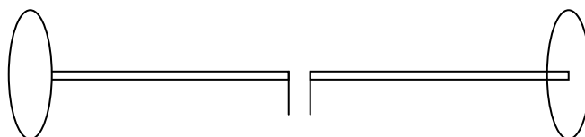
Fig. 2.17. Antena dipol cu discuri conductoare.
